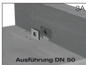
1.4 Schiebeflansch (Ausführung DN 70 und DN 100, mit zusammengerollter Anschlussmanschette) bzw. Schiebeflansch (Ausführung DN 50, mit Kompressionsdichtungen) mittels Schlitzschraubenzieher befestigen (Bild 3 bzw. 3A).
